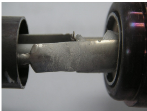
○2センサー内部に浸水した事例
