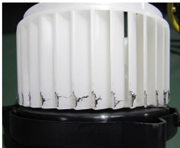
異物によりファンが損傷した事例
