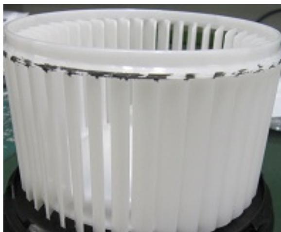
車両側へ斜めに装着した事で、ファンが損傷してしまった事例
