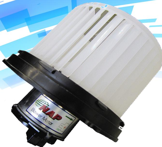
ブローモーターは、モーターと円筒形のファン（シロッコファン）を組み合わせたファンモーターです。インナーパネル内にあるヒーターケースに装着されており、車内へ風を送り出します。ブローモーターで発生させた気流は、エバポレーターやヒーターコアを通過して冷暖房が効く仕組みです。車種によって、取付される向きや位置が若干変わりますが、ダッシュボード下や、助手席側足元等に装着されています。
