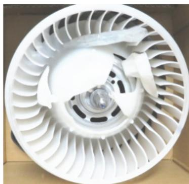
落下によるファン損傷
