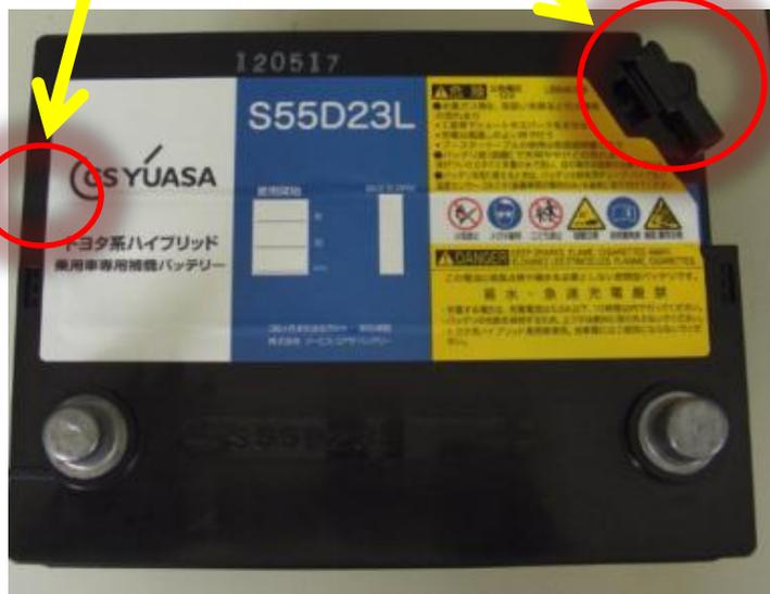
エスティマ ハイブリッド(AHR10W)には車両側に温度センサーコネクタに接続する配線がありません。バッテリーの温度センサーコネクタには何も接続しないでください
