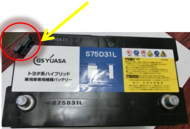
② プラス端子側側面シール箇所 (排気口反対側)
