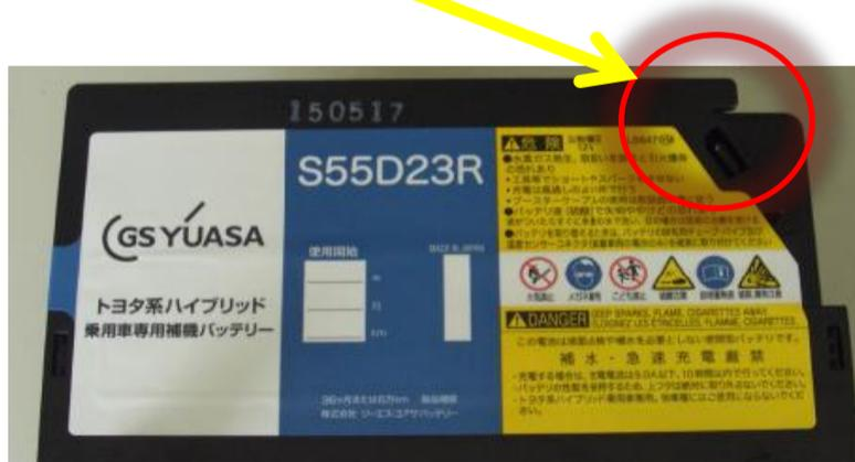
② プラス端子側側面シール箇所 (排気口反対側)
