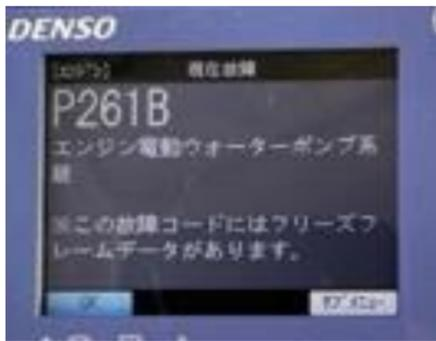
故障コード「P261B」は、「エンジン電動ウォーターポンプ系統」
